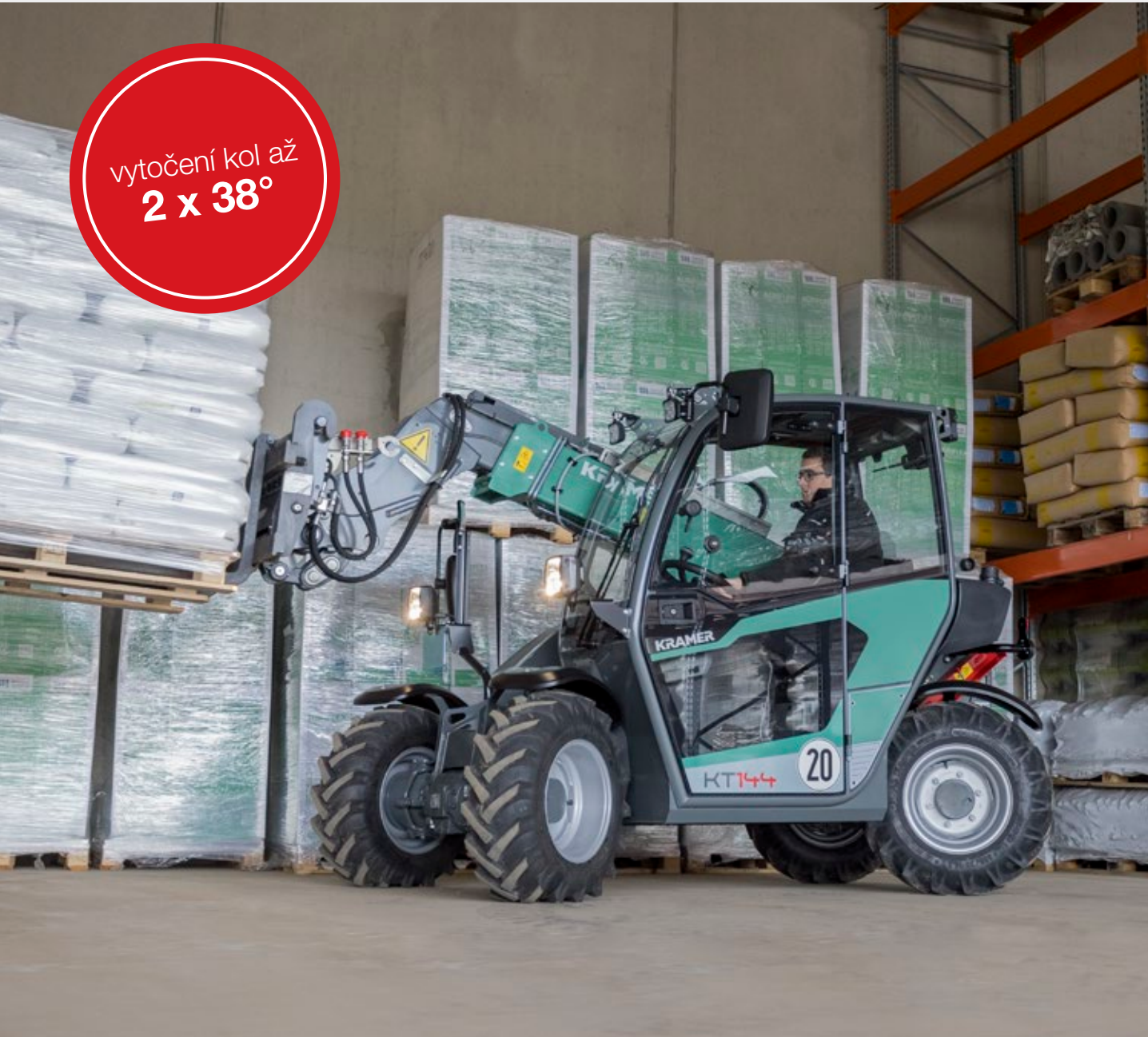
Řízení všech kol: pro špičkovou obratnost zejména v těsných prostorech
