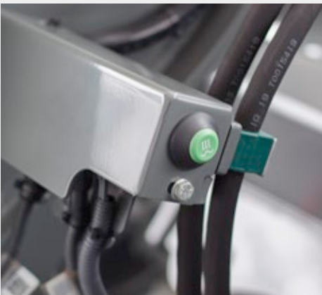
Odtlakování 3. okruhu tlačítkem: Snadné připojení a odpojení hydraulicky ovládaného nářadí.
