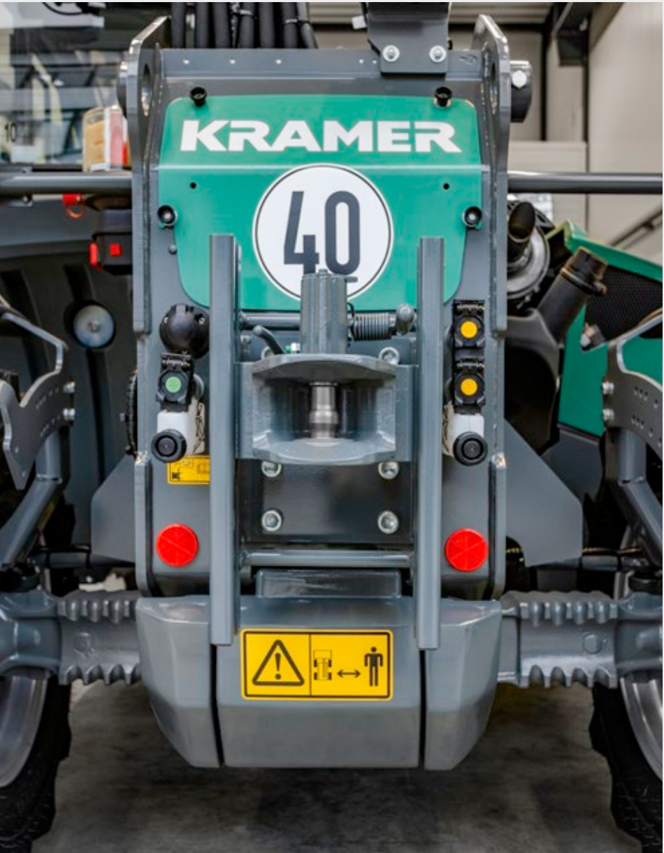
Vnější ovládání příslušenství (KT276) pro třibodový závěs a PTO.
