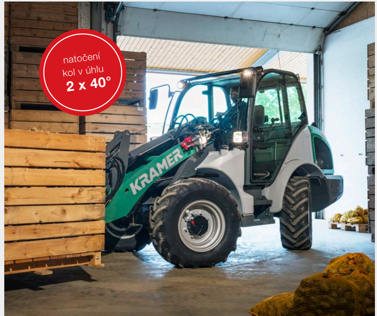
Řízení všech kol pro bezkonkureční poloměr otáčení
