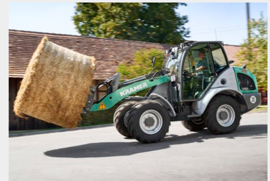
Řízení pouze předních kol pro vyšší bezpečnost při rychlých přesunech
