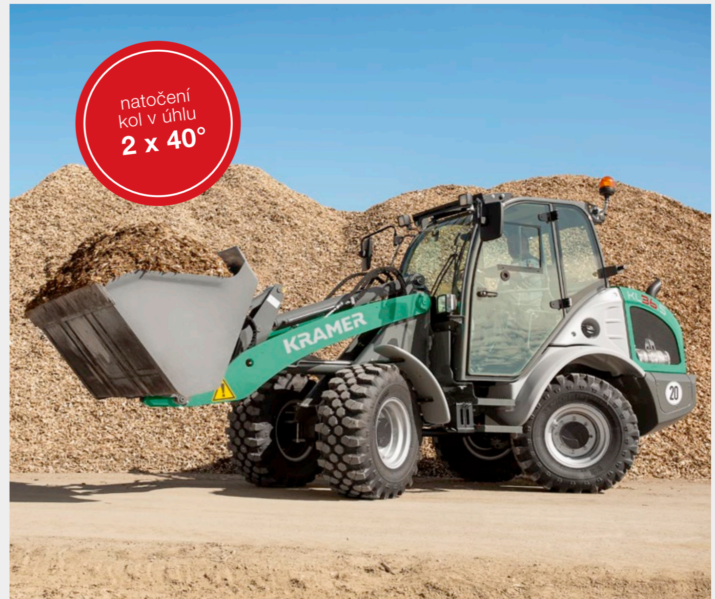
Řízení všech kol pro bezkonkurenční poloměr otáčení
